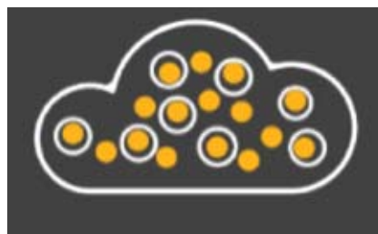
4. Процесс обволакивания пыли водяным туманом
