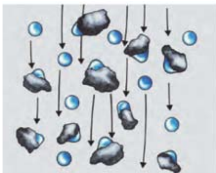
РИС. 2. ПРОЦЕСС ВЗАИМОДЕЙСТВИЯ КАПЕЛЬ ВОДЫ С ЧАСТИЦАМИ ПЫЛИ
