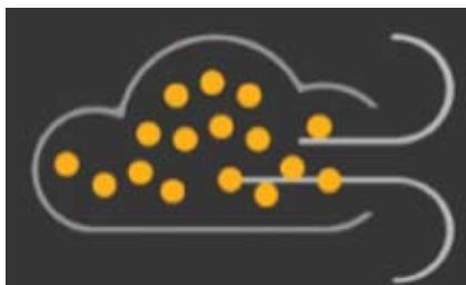
2. Процесс обволакивания пыли водяным туманом
